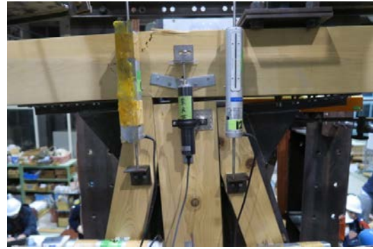
写真7 補強金物の破壊の様子
